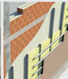
Fachada ventilada con subestructura metálica fijada a una hoja principal de bloque Termoarcilla
