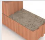
Montaje 1: Junta horizontal de mortero continua
