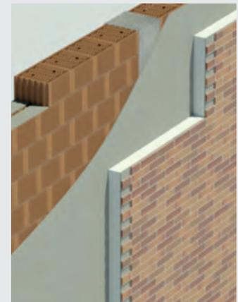
Figura 7: Solución constructiva de muro de una hoja con panel aislante con plaqueta cerámica vista
