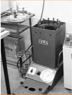
Autoclave empleado para presiones de 1 MPa
