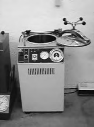
Autoclave empleado para presiones de 0,2 MPa
